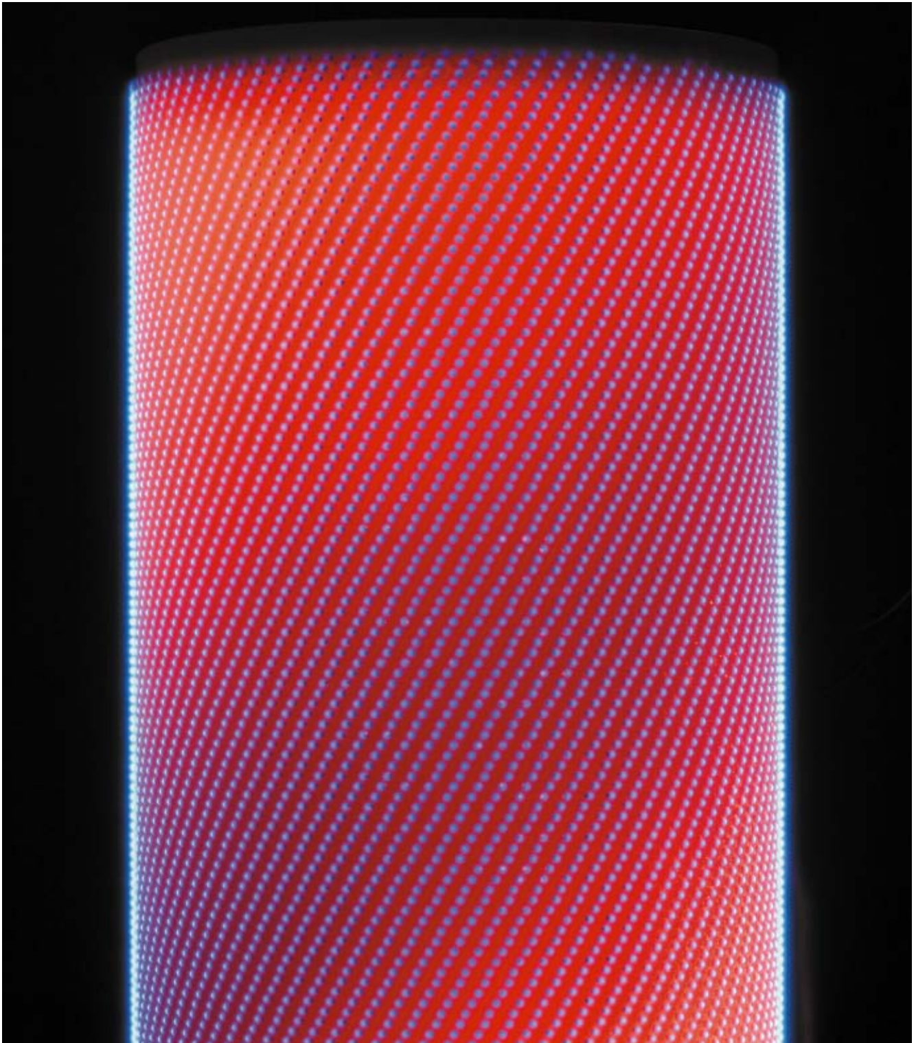
Tapis de flamme du brûleur fioul premix modulant.
