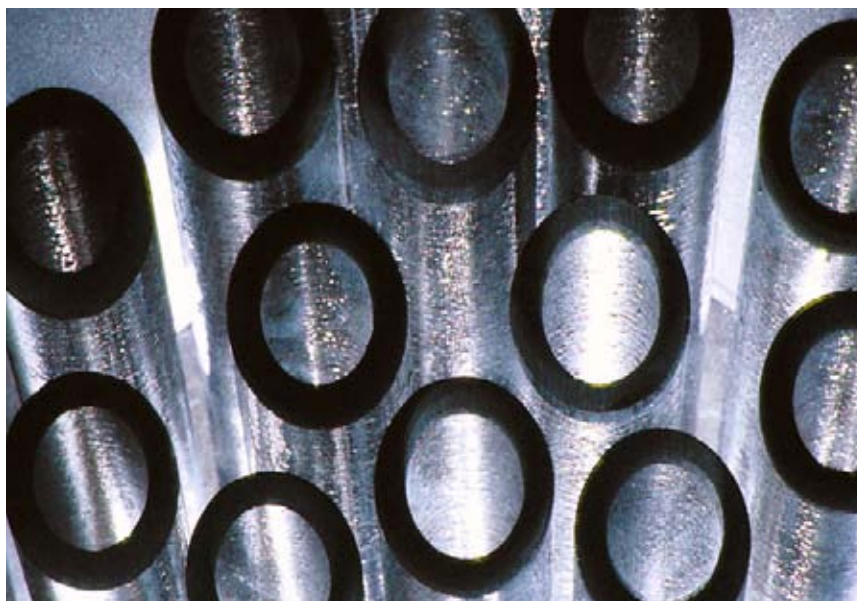
Echangeur formé de tubes en céramique résistant à la condensation acide
