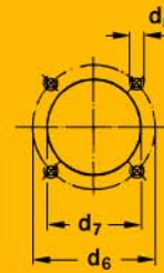
Perçage de la plaque de façade
