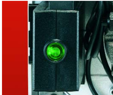
Les phases de marche et de défaut sont visualisées par des LED de couleur
